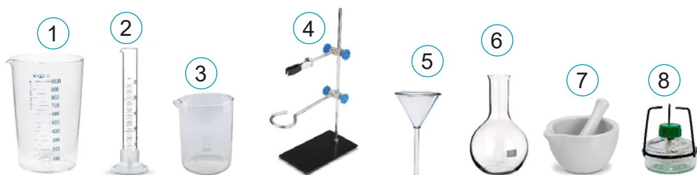
Мал. 21. Лабораторне обладнання: 1 – мензурка; 2 – мірний циліндр; 3 – склянка; 4 – штатив; 5 – лійка; 6 – колба; 7 – ступка з товкачиком; 8 – спиртовий пальник
