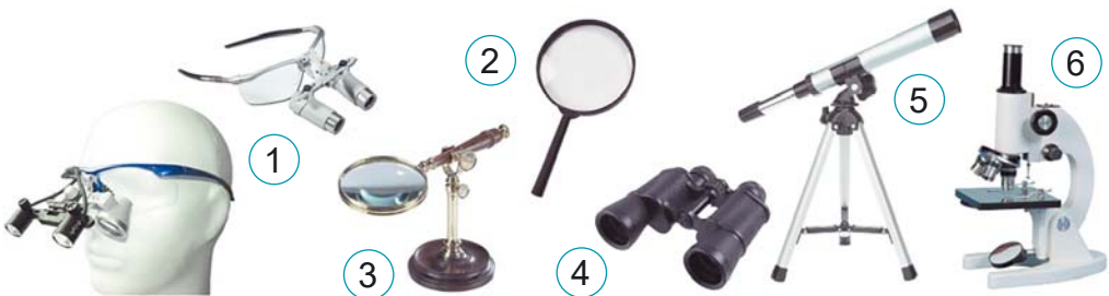
Мал. 20. Збільшувальні прилади: 1 – біноклярна лупа; 2 – лупа; 3 – штативна лупа; 4 – бінокль; 5 – шкільний телескоп; 6 – мікроскоп
