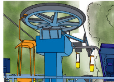
Рис. 35.3. Нерухомий блок у механізмі канатної дороги змінює напрямок дії сили натягу каната (а отже, напрямок руху каната) на протилежний
