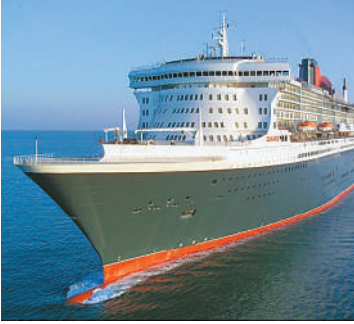
Рис. 29.2. Корпус суден фарбують у два кольори. Зазвичай корпус пофарбований так, що вище від ватерлінії він чорний або білий, а нижче — відповідно червоний або чорний
