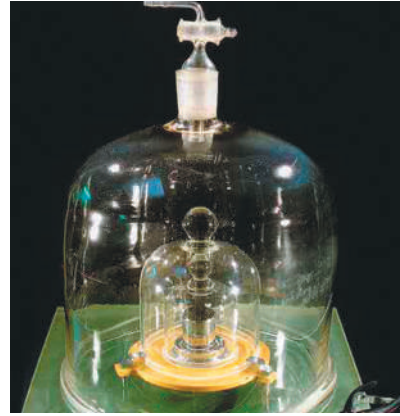
Рис. 15.4. Міжнародний еталон кілограма: а — розміри; б — умови зберігання
