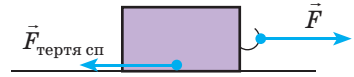
Рис. 21.2. Сила \vec{F} , яка намагається зрушити тіло, і сила тертя спокою \vec{F}_{\text{тертя сп}} , що при цьому виникає, зрівноважують одна одну — тіло перебуває в стані спокою
